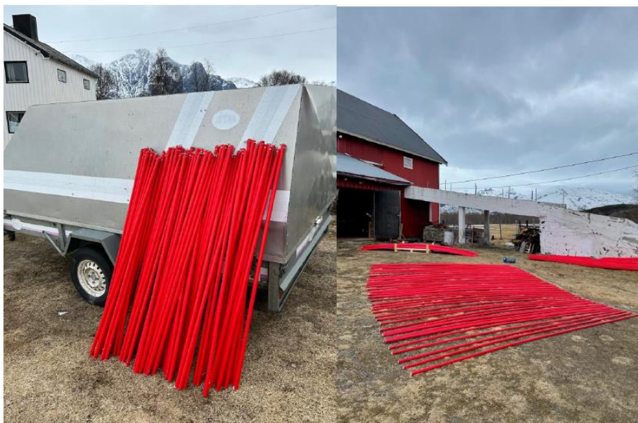
Figur 9: Brøytestikker ferdig korket og sjaklet klare for å monteres i lengder på 5 m. Foto: Reisa Elvelag.
